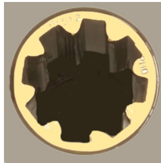
C1512 ГАЙКА ЗАЖИМА ИЗНОШЕННАЯ НА 50%
