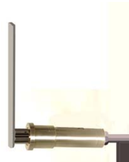
C1512 ГАЙКА ЗАЖИМА ИЗНОШЕННАЯ НА 100%
