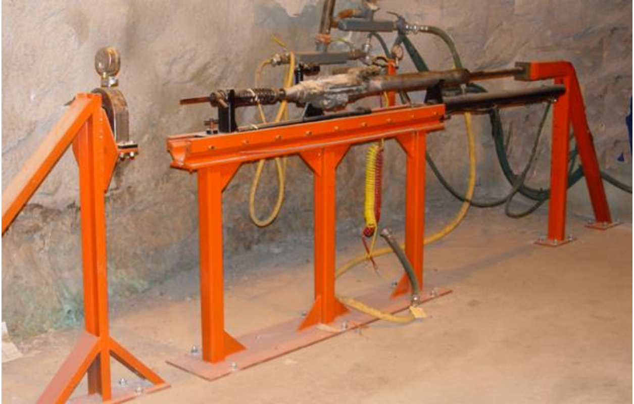
НА РИСУНКЕ ПОКАЗАН ПЕРФОРАТОР STOPER В ПРОЦЕССЕ ИСПЫТАНИЯ
