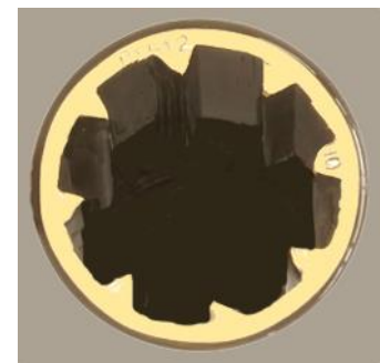
ПОВОРОТНАЯ БУКСА C1512, ИЗНОС 100%
