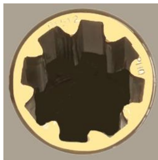
ПОВОРОТНАЯ БУКСА C1512, ИЗНОС 50%
