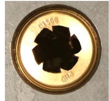
ШЛИЦЕВАЯ ГАЙКА C1508, ИЗНОС 100%
