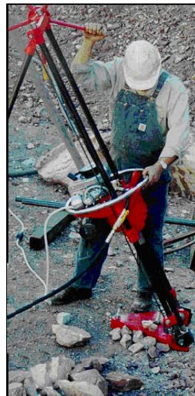
**Силовой агрегат** – 2-тактный бензиновый двигатель воздушного охлаждения
