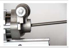
**27.** Снять уплотнение водной трубы (54) и заменить в порядке текущего техобслуживания. Это очень недорогая деталь, однако, ее поломка может привести к отказу перфоратора во время работы.
