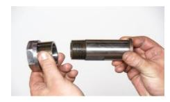
19. Извлечь кольцевую прокладку (67) из гайки стержня воздуха (69) и проверить прокладку на предмет наличия признаков износа или повреждения. Кольцевые прокладки недороги, и подлежат замене даже в случае небольшого истирания или повреждения. Кольцевую прокладку нужно покатать между пальцами, чтобы убедиться, что она все еще мягкая и податливая, что в ней нет зон, которые становятся хрупкими при использовании.
