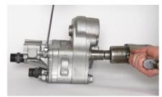
4. Снять четыре контргайки (29) и четыре болта (16), а также восемь стопорных шайб (15) и восемь плоских шайб (16) Осмотреть болты и гайки, а также шайбы на предмет износа или повреждения, а также заменить их при необходимости
