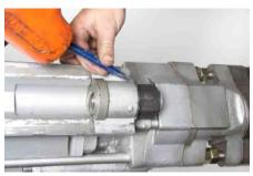
**2.** После выправления накладок с помощью регулируемого ключа ослабить гайку для гайки винта подачи (48) на гайке винта подачи (46).
