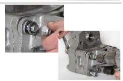
**50.** Провести две шпильки (19) (используются для закрепления мотора подачи SASTANMO в алюминиевом корпусе) две стопорные шайбы (15) и гайки (36) через узел и надеть пластину подачи (3) на болты.
