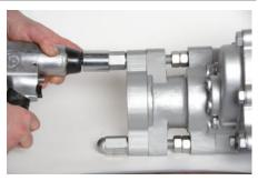
7. Снять переднюю стопорную пластину (41). При необходимости использования нового буродержателя проверить внутреннюю часть стопорной пластины на предмет износа или истирания поверхности, что может повредить новый буродержатель.
