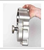
71. Осмотреть вал ведомой шестерни (37) и саму ведомую шестерню (33). Осмотреть подшипник (32). PHQ рекомендует выполнять замену подшипника при повторной сборке перфоратора.
