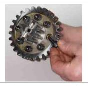
66. Снять блок шестерен (25) с шестеренчатого привода (24).
