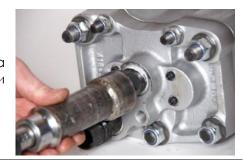
**52.** При повторной установке воздушных соединений шлангового патрубка (11) необходимо нанести на резьбу противозадирный состав.
