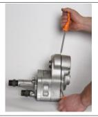
**9.** Снять заднюю крышку (17) с передней крышки (8). Осмотреть поверхности компонентов на предмет износа или коррозии, а также заменить при необходимости.
