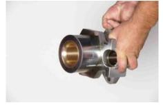
79. Снять бронзовую прокладку переднего цилиндра (30) с переднего цилиндра (31). Обычно эта операция выполняется в мастерской с использованием пяти десятитонного пресса. Заменить старую прокладку на новую с помощью того же пресса для надежного вдавливания ее в передний цилиндр. Эта процедура выполняется в мастерской, однако узел можно заменить и под землей.
