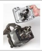
**51.** С помощью шуруповерта и разъема  $1 \frac{1}{4}$ " выкрутить два воздушных соединения (11) шлангового патрубка с задней крышки мотора вращения
