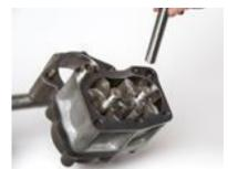
**54.** Снять корпус мотора вращения (5) с передней крышки мотора вращения (7) и осмотреть поверхности корпуса на предмет наличия признаков точечной коррозии поверхности или износа. Проверить внутреннюю часть редуктора, чтобы убедиться, что там нет задир или износа, вызванных попаданием внутрь перфоратора инородных
