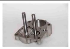
**61.** Снять меньший (9) шестеренчатый привод и проверить зубцы шестерни на наличие признаков точечной коррозии поверхности или повреждений. Заменить при необходимости.
