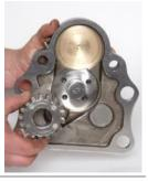
42. Надавить задней крышкой (17) на переднюю крышку (8), следя за тем, чтобы попасть шестернями ведомой шестерни (3) между зубцами ведущей шестерни (18) и зубцами редуктора (20). После сборки узла повернуть роторы, чтобы «почувствовать», что шестерни двух компонентов сработались нормально.
