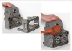
**44.** Нанести на внутреннюю часть крышки пневматического мотора (10) консистентную смазку для перфоратора, совместить два вала и четыре установочных рукава, проходящих через роторы в корпусе, и с усилием надавить крышку пневматического мотора на узел.
