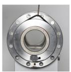
**5.** Установить шляпковые уплотнения (9) в рукава (8), уже вдавленные в головку опоры (18). Нанести консистентную смазку.
