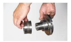
38. Достать поршень (29) из цилиндра перфоратора (43).
