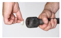
**33.** Снять прокладку задней головки (59) с цилиндра перфоратора (43) и осмотреть ее на наличие признаков износа на поверхностях детали. Эта деталь обеспечивает надежное удерживание клапанной коробки (64) на месте при затягивании стяжных болтов до нужного момента.
