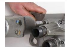
18. Извлечь четыре винта с головкой под ключ (32) и четыре стопорные шайбы (31) из пластины переходника (13). Заменить изношенные или поврежденные винты с головкой и стопорные шайбы.
