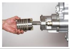
**9.** Открутить контргайки (82) со стяжного болта в пространстве между фланцами на передней головке (52). Проверить гайки на предмет износа и заменить эти недорогие детали, если будут обнаружены какие-либо признаки их износа.
