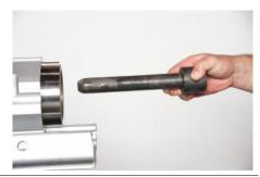
**32.** Снять уплотнение (57) с имитирующей винтовой направляющей и заменить в порядке текущего техобслуживания. Это очень недорогая деталь, однако, в случае ее отказа с перфоратором могут возникнуть проблемы.
