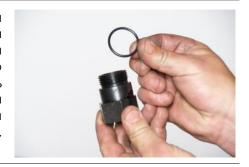
**22.** Снять упорную подушку (76) из внутренней части впуска в заднюю головку (55), где накручивается гайка воздушного загиба(74). Проверить упорную подушку на предмет износа и при необходимости заменить.
