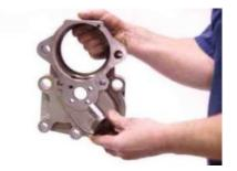
73. Перед повторной сборкой перфоратора заменить два подшипника (16) в передней крышке мотора вращения (7) с помощью гидравлического пресса в мастерской.
