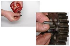
33. Вставить вал ведомой шестерни (35) в заднюю крышку (17).
