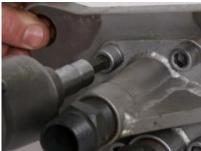
19. Снять пластину переходника (13) (вместе с двумя шланговыми патрубками (22)) с крышки пневматического мотора (10). Осмотреть сопряженные поверхности двух компонентов для проверки их на предмет износа или повреждения. Заменить при необходимости.
