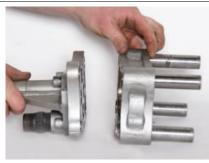
17. С помощью ударного ключа и шестигранного ключа ослабить четыре винта с головкой под ключ (32), удерживающие пластину переходника (13) на крышке пневматического мотора (10).
