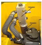
**Выхлопной воздушный коллектор PHQ4002** производится с портами, просверленными через алюминиевый блок, и установлен с глушителем PHQ4003 для сокращения уровня выхлопного шума из пневматического двигателя гидронасоса.
