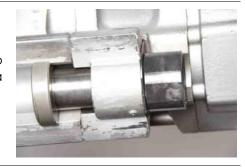
**3.** Снять гайки винта подачи (46) и проверить внутреннюю резьбу на предмет отсутствия признаков повреждений или износа. Заменить гайку для гайки винта подачи (48).
