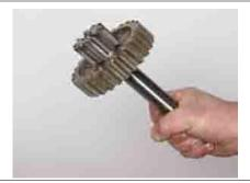
**64.** Если блок шестерен (25) поврежден, ослабить шесть винтов с головкой под ключ (6), удерживающих блок на шестеренчатом приводе (24).
