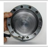
10. Нанести на головки поршней консистентную смазку. Разместить два цилиндра (2) открытым концом на головках выступающих поршней (4) на каждой стороне головки опоры (18). Подогнать цилиндры с помощью пятифунтовой пластиковой колотушки.
