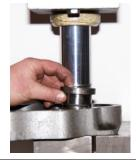
**30.** С помощью пяти десятитонного пресса (или низкого давления) вдавить два новых подшипника (27) в переднюю крышку (8).
