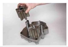
**56.** Снять ротор мотора вращения (17), проверить зубцы редуктора на наличие возможных признаков повреждения или задиров.
