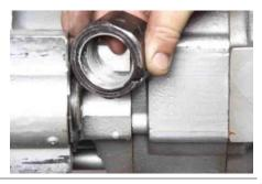
**4.** Снять контровочную пластинчатую шайбу (47) с гайки винта подачи (46). Выбросить старую шайбу и заменить ее на новую при повторной сборке перфоратора.
