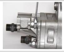
**5.** Захватить правую скобу мотора (28) и левую скобу мотора (12), и снять их с узла. Проверить скобы на наличие признаков повреждения или растрескивания. Заменить при необходимости.
