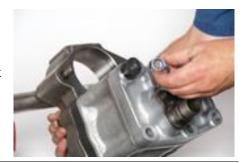
**47.** Снять три винта с головкой (4) и два винта с головкой (13) с узла мотора вращения.
