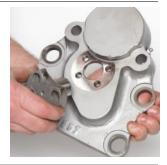
**34.** Разместить четыре стопорных шайбы (34) на четырех винтах с головкой под ключ, нанести на резьбу всех четырех винтов с головкой (33) Loctight и вкрутить винты с головкой через вал ведомой шестерни (35) в заднюю крышку (17).
