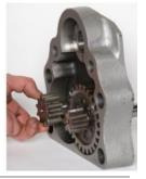
**39.** Вставить клин (6) в разъем в валу ведущей шестерни (18) проходящей через переднюю крышку, и надеть большой ротор (9) на вал ведущей шестерни (18) по клину (6), таким фиксируя ротор в нужном положении.
