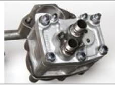
41. С помощью шуруповерта и разъема 1" ослабить две контргайки (36), удерживающие два маленьких винта с головками (12). Проверить контргайки и винты с головками на предмет наличия признаков износа и заменить при необходимости. При сборке мотора две контргайки (36) необходимо затянуть с моментом 115 Нм (85 ф/ф).
