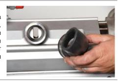
**29.** Снять два выходных рукава цилиндра (44) и проверить резьбу на предмет износа. Заменить при необходимости.
