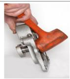
**22.** С помощью электродрели с шестигранным ключом, вставленным в буро держатель, открутить шесть винтов с головкой под ключ (4), высвобождая редуктор (20) из ведущей шестерни (20).
