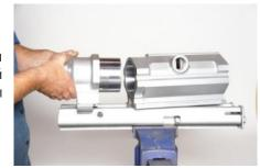
77. Для установки передней шайбы цилиндра (31) в цилиндр (43) две детали нужно провести в короткую часть стрелы податчика (со стороны узла подачи) и постучать по ним резиновым молотком для правильного совмещения деталей до того как передняя шайба цилиндра будет вжата в цилиндр (43) с применением пятидесятитонного гидравлического пресса в мастерской
