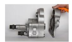
**10.** Вставить отвертку между передней крышкой (8) и корпусом (8) на моторе подачи и аккуратно разделить эти детали.
