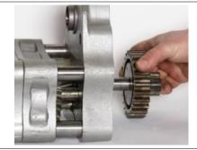
**13.** Снять переднюю крышку (8) с корпуса мотора (26). Осмотреть поверхности двух компонентов на предмет наличия повреждений или признаков коррозии.
