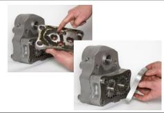
**45.** С помощью пластиковой колотушки пригнать крышку пневматического мотора (10) плотно к передней крышке (8) и задней крышке (17) корпуса (26).
