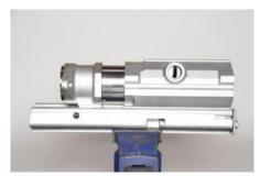
**78.** Осмотреть бронзовую прокладку переднего цилиндра (30) в переднем цилиндре (31) на наличие царапин и износа. Прокладка обеспечивает хорошее сжатие в перфораторе и подлежит замене при обнаружении первых царапин и признаков износа.
