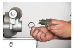
**26.** Отсоединить водную трубу (54) от перфоратора. Проверить водную трубу на предмет износа в зоне, где штанга хвостовика будет вращаться на водной трубе. Заменить, если она изогнута, сжата или изношена.
