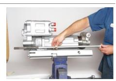
13. Захватить корпус понижения (34), который является частью узла мотора вращения(\$36IRROTMO), и потянуть для отделения всего узла от шайбы переднего цилиндра (31). Корпус будет снят вместе с приводными шестернями, воздушным мотором и фитингами подключения воздуха на месте. Отложить мотор в сторону для последующего демонтажа. Проверить соприкасающиеся поверхности между мотором и передним цилиндром на предмет износа.
