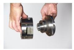
37. Удерживая заглушку клапанной коробки (66), снять клапан (65) со стержня заглушки клапанной коробки. Осмотреть детали на предмет наличия признаков износа, повреждений или коррозии. Тщательно очистить эти детали и нанести на них тонкий слой масла перед повторной сборкой клапанного узла.
