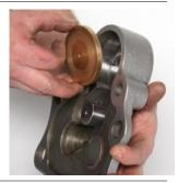
**37.** Продеть малую шестерню (19) редуктора (20) через подшипник (27) и вставить в переднюю крышку (8).
