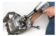
**46.** Снять контргайки (23) и стопорные шайбы (14) с конца трех винтов с головкой (4) и двух винтов с головкой (13).
