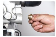
**23.** Разобрать узел водо-воздушного стержня, сняв уплотнение водо-воздушного стержня (71), кольцевую прокладку (72) и упорную шайбу (77). Проверить все детали на отсутствие износа и заменить при необходимости.
