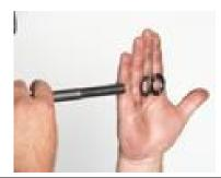
**49.** Ослабить заднюю крышку мотора вращения (3) в корпусе мотора вращения (5). Для разделения этих двух компонентом может потребоваться слегка помочь себе молотком.
