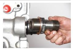
**17.** Снять медную шайбу гайки стержня воздуха (68) с гайки стержня воздуха. Проверить шайбу на предмет износа и заменить, если она изношена или на ней, если следы коррозии.
