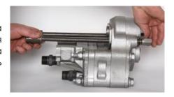
**3.** Приступить к демонтажу отказавшего SASTANMO с использованием пневматического шуроповерта и разъема под головку болта (16) и удерживая контргайку (29) простым ключом.
