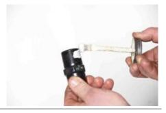
**53.** Снять два установочных рукава (22) с корпуса мотора вращения (5). Здесь может понадобиться помощь бронзовой отвертки и молотка для высвобождения рукавов из корпуса.
