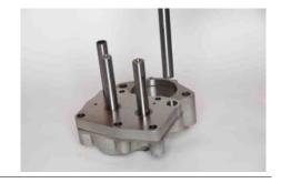
**59.** Снять переднюю крышку мотора вращения (7) с корпуса понижения (34) и осмотреть внутреннюю часть крышки на наличие каких-либо признаков износа или задиров. Заменить при необходимости.
