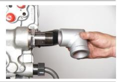
**16.** Скрутить гайку стержня воздуха с задней головки (55), при этом важно не потерять медную шайбу гайки стержня воздуха (68)
