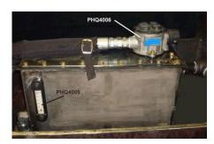
**PHQ 4006 Фильтр гидравлического масла** установлен на верхней части маслобака, фильтрующий обратно-поступающие жидкости до частоты в 5 микрон.
