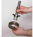
**67.** С помощью трещоточного ключа и шестигранного ключа ослабить четыре винта с головкой под ключ (39), удерживающие вал ведомой шестерни (37) в корпусе понижения (34).
