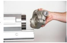
31. Снять имитирующую винтовую направляющую (58) и осмотреть ее на предмет наличия признаков износа. Эта деталь используется в качестве «фильтра» в отверстии, где винтовая направляющая работает во вращающемся перфораторе с винтовой направляющей. Эта деталь не имеет критического значения и подлежит замене только в случаях экстремального износа или коррозии, которые могут повредить детали, находящиеся рядом с ней в перфораторе.
