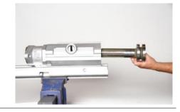
39. Осмотреть ударную поверхность поршня на наличие признаков износа, причиной которых может быть хвостовик перфоратора. Сравнить изношенную поверхность (слева) с новой поверхностью (справа). Ударный конец поршня можно отшлифовать до глубины максимум 1/8ая дюйма. Проверить головку поршня на предмет задирания поверхности или признаков выгорания или износа поверхности из-за недостатка смазки. Заменить в случае наличия износа или задиров.
