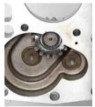
**72.** Осмотреть корпус шестерни (34) на наличие признаков коррозии или износа на поверхностях компонента и внутри ведомой шестерни. Осмотреть корпус на наличие каких-либо возможных трещин или повреждений.
