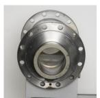
3. Для вдавливания двух рукавов (8) с каждой стороны головки опоры (18) используется пяти десятитонный пресс
