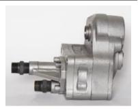
**7.** Постучать по верху задней крышки (17) с помощью 3фунтовой пластиковой колотушки, чтобы отделить корпуса от передней крышки (8)
