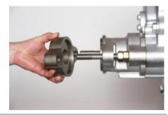
8. Извлечь буродержатель (51) из внутренней части передней головки (52). Проверить внутреннюю часть буродержателя, вставив новую штангу хвостовика и повернув ее, чтобы измерить износ. Проверить поверхности буродержателя на наличие признаков износа, который может быть вызван недостатком смазки. Проверить проушины на буродержателе (51), которые сопряжены с редуктором буродержателя (49) на наличие каких-либо признаков износа или повреждения соприкасающихся поверхностей.
