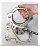
**68.** Извлечь четыре винта с головкой под ключ (39) из четырех стопорных шайб (38).
