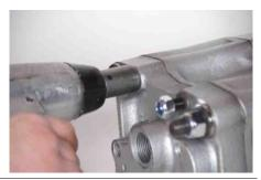
**42.** Заменить стопорные шайбы (14) и плоские шайбы (15) под контргайками (23). Очень важно, чтобы винты с головками (12) были жестко зафиксированы, и это недорогие детали нужно всегда заменять, таким образом, PHQ рекомендует иметь достаточное количество этих деталей в запасе в мастерской.
