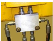
**Цилиндр балансировки траверсы в сборе** регулирует давление гидравлической жидкости, задерживающейся в подъемных цилиндрах для правильной позиции траверсы и перфоратора.
