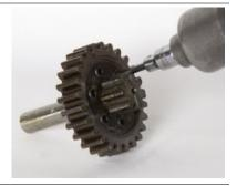
**23.** Снять блок редуктор (20) с ведущей шестерни (20). Осмотреть редуктор на предмет наличия поврежденных зубцов или растрескивания поверхности редуктора. Проверить вал на предмет износа или коррозии. Заменить при необходимости.
