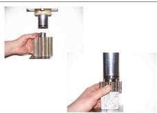
**76.** Снять переднюю шайбу цилиндра (31) с цилиндра (43) Для этого, скорее всего, потребуется 20-тонный гидравлический пресс. Осмотреть поверхности, где поверхность передней шайбы цилиндра и цилиндра встречаются на наличие признаков износа.
