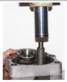
**27.** С помощью пяти десятитонного гидравлического пресса (или низкого давления) вдавить новый подшипник (27) в переднюю крышку (8).
