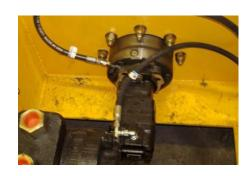
Тормозной механизм состоит из четырех распределителей и четырех тормозов, установленный на оси, соединяющей приводные двигатели PHQ4009 и четыре приводные ступицы PHQ4010.
