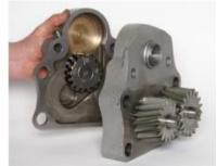
**43.** Вставить четыре установочных рукава (21) в соответствующие отверстия в корпусе (26). Совместить четыре установочных рукава с соответствующими отверстиями в передней крышке и сжать узел в собранном виде. Подогнать компоненты друг к другу с помощью трехфунтовой пластиковой колотушки.
