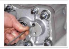
**44.** Снять маленький винт с головкой с углублением под ключ (1) и пружинную шайбу (2), и осмотреть их на предмет наличия признаков износа и повреждения. Заменить обе детали при необходимости.
