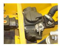
РНQ4001 Пневматический двигатель направляет отработанный воздух в выхлопной воздушный коллектор в сборе РНQ4002. Выхлопной коллектор в сборе включает в себя выхлопной воздушный коллектор РНQ4002 и глушитель РНQ4003, сокращающий уровень шума.
