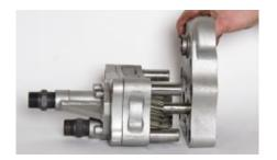
**14.** Снять большой ротор (9) и вал с вала шестеренчатого привода (18), проходящего через переднюю крышку (8). Проверить ротор на предмет износа или растрескивания. Проверить вал шестеренчатого привода и клин (6). Заменить все поврежденные части.
