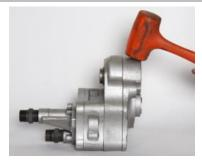
**8.** После появления небольшого зазора вставить отвертку между задней крышкой (17) и передней крышкой, и аккуратно разделить крышки.
