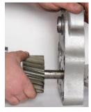
**15.** Вставить две отвертки в зазор между корпусом мотора (26) и крышкой пневматического мотора (1) и аккуратно разделить два компонента.
