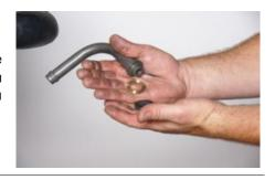
**24.** Снять заглушку водной трубы (61) с задней головки (55). Проверить резьбу на заглушке, чтобы убедиться, что она не изношена.
