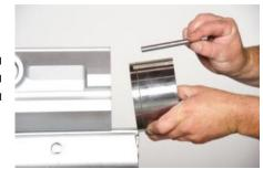
36. Удерживая клапанную коробку (64), снять заглушку клапанной коробки (66) с самой коробки. Может понадобиться упереть бронзовую отвертку в центр заглушки клапанной коробки и достать ее из клапанной коробки с помощью молотка. Необходимо соблюдать осторожность, чтобы не повредить критические детали, так как их замена весьма дорога.
